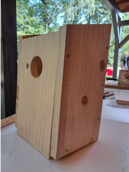
Die Front wird nur mit zwei Nägeln im oberen Drittel des Kastens befestigt. Dadurch kann sie aufgeklappt werden. So kannst du den Kasten im Winter reinigen. Wenn du die Front positioniert hast, schlage also links und rechts jeweils einen Nagel der Länge 4 cm in die Vorbohrungen der Seitenteile ein. An dieser Stelle ist es wichtig, dass du Nägel benutzt, auch wenn du sonst Schrauben nimmst. Sonst kannst du den Kasten später nicht mehr öffnen.
