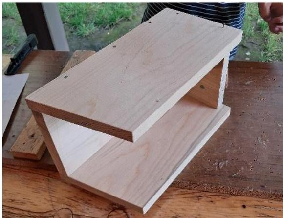
Als nächstes kommt die andere Seitenwand dran. Baue diese Seite an der Rückwand und am Boden mit 4 cm langen Nägeln an. Tipp: Stecke hier bereits die Front an ihre Position.
