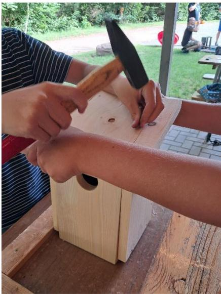
Das Dach schließt hinten mit der Wand ab und steht vorne über, so kann es nicht in den Kasten regnen. Lege das Dach also nach hinten Kante an Kante auf und achte darauf, dass es an den Seiten gleichmäßig übersteht. Die Vorbohrungen müssen so liegen, dass sie genau über den Seitenteilen und der Rückwand positioniert sind. Befestige das Dach mit Nägeln der Länge x mm an den Vorbohrungen. Die Front darf nicht am Dach befestigt werden, sonst kann der Kasten nicht mehr geöffnet werden.
