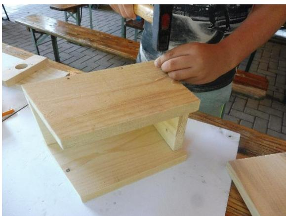
Als nächstes kommt die andere Seitenwand dran. Baue diese Seite an der Rückwand und am Boden mit 4 cm langen Nägeln an.
