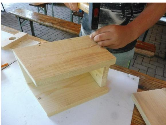
Als nächstes kommt die andere Seitenwand dran. Baue diese Seite an der Rückwand und am Boden mit 4 cm langen Nägeln an. Tipp: Stecke hier bereits die Front an ihre Position.
