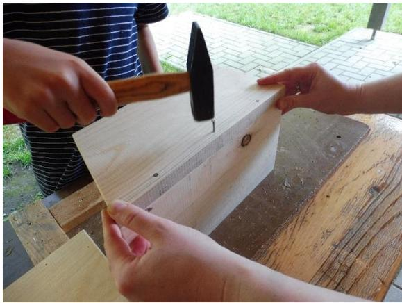
Starte mit einem Seitenteil und der Rückwand. Setze beide Teile zusammen und achte darauf, dass die abgeschrägte Kante der Rückwand nach oben zeigt und die Schräge in dieselbe Richtung geht wie die Schräge der Seitenwand.
