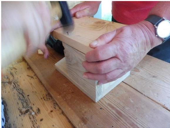
Die Front wird nur mit zwei Nägeln im oberen Drittel des Kastens befestigt. Dadurch kann sie aufgeklappt werden. So kannst du den Kasten im Winter reinigen. Wenn du die Front positioniert hast, schlage also links und rechts jeweils einen Nagel der Länge 4 cm in die Vorbohrungen der Seitenteile ein. An dieser Stelle ist es wichtig, dass du Nägel benutzt, auch wenn du sonst Schrauben nimmst. Sonst kannst du den Kasten später nicht mehr öffnen.
