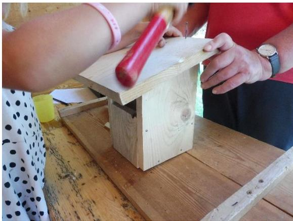
Das Dach schließt hinten mit der Wand ab und steht vorne über, so kann es nicht in den Kasten regnen. Lege das Dach also nach hinten Kante an Kante auf und achte darauf, dass es an den Seiten gleichmäßig übersteht. Die Vorbohrungen müssen so liegen, dass sie genau über den Seitenteilen und der Rückwand positioniert sind. Befestige das Dach mit Nägeln der Länge x mm an den Vorbohrungen. Die Front darf nicht am Dach befestigt werden, sonst kann der Kasten nicht mehr geöffnet werden.
